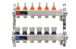
DISTRIBUITOR INCALZIRE PARDOSEALA, 1", 9 CAI, CU DEBITMETRE, AERISITOR MANUAL, ERMETIQ
