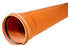
TEAVA PVC, PENTRU CANALIZARE EXTERIOARA, D 125 X 3.7 MM, L 4 M
